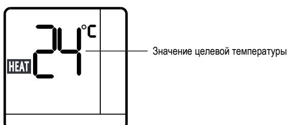
Для быстрого включения кондиционера в режим ОБОГРЕВ, нажмите **HEAT**
